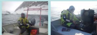
Pomiary za pomocą sondy CTD (zasolenie, temperatura, głębokość)
