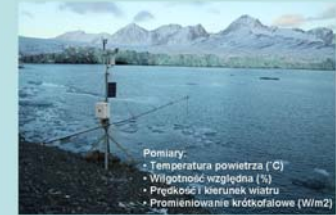
Automatyczna stacja meteorologiczna w Hornsundzie
