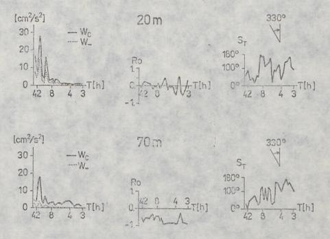
Fig. 2. Rotation spectrum W, rotation coefficient  $R_o$ , and orientation of the main axis of current ellipse  $S_T$  at point I at depths 20 and 70 m Rys. 2. Widmo rotacji W, współczynnik rotacji  $R_o$ , orientacja osi głównej elipsy
