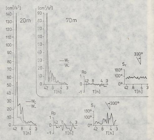
Fig. 3. Rotation spectrum W, rotation coefficient  $R_o$ , and orientation of the main axis of current ellipse  $S_T$  at point II at depths 20 and 70 m Rys. 3. Widmo rotacji W, współczynnik rotacji  $R_o$ , orientacja osi głównej elipsy prądów  $S_T$  w punkcie II na głębokości 20 i 70 m
